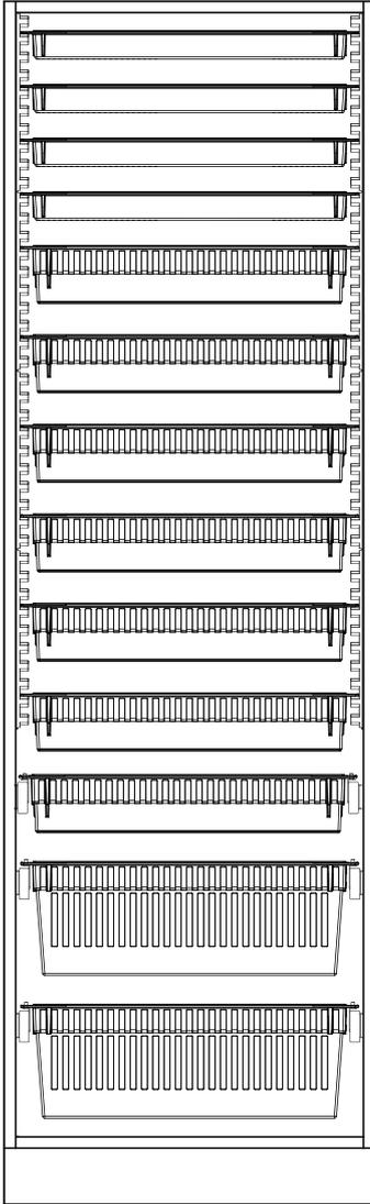
ISO 400 tief mit Trägerwand und Teleskopauszügen mit Modulen in verschiedenen Höhen
