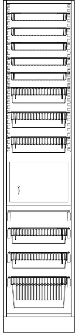
ISO 600 tief mit Trägerwand und Teleskopauszügen mit Modulen in verschiedenen Höhen
